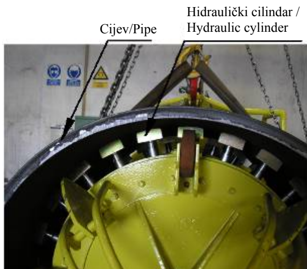
Slika 5. Pozicioniranje cijevi na tokarilici-glodalici pomoću ventila Figure 5. Pipe positioning on the lathe-milling machine
